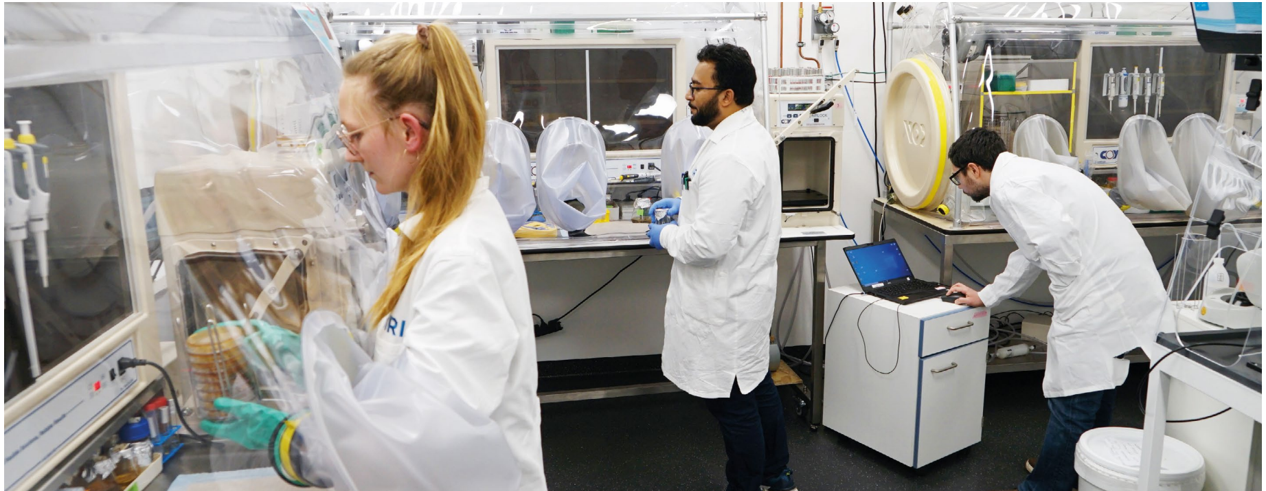
Anaeroben-Kammer: Um anaerobe Darmbakterien zu untersuchen, müssen im Labor darmähnliche Bedingungen simuliert werden. Dazu erzeugen wir mithilfe anaerober Werkbänke eine sauerstofffreie Umgebung, welche das Wachstum von strikt anaeroben Darmbakterien ermöglicht. © Hilde Merkert
