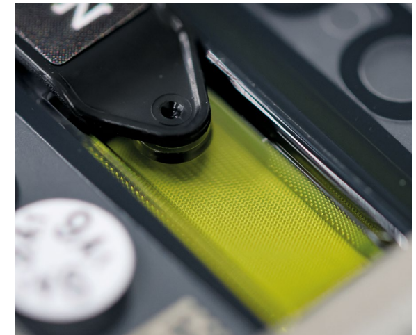
Nanoporen-Durchflusszelle, eingesetzt in ein ONT-MinION-DNA-Sequenziergerät. Quelle: AG Suerbaum, Max von Pettenkofer-Institut
