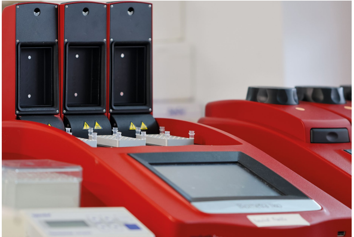
Thermocycler für die DNA-Amplifikation mittels Polymerase-Kettenreaktion. Quelle: AG Suerbaum, Max-von-Pettenkofer-Institut
