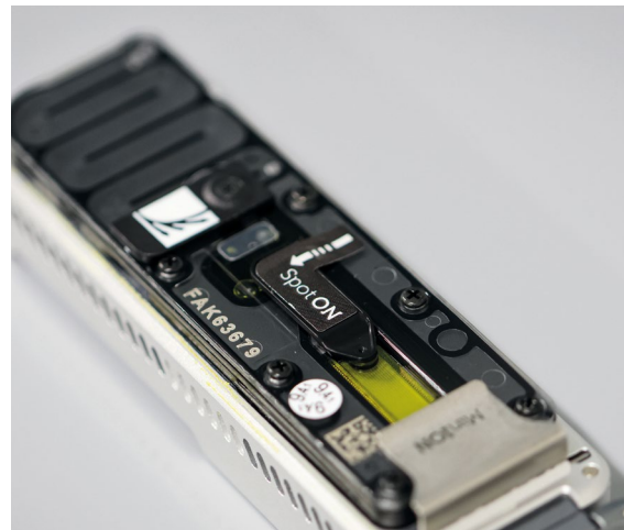
Nanoporen-Durchflusszelle in ein ONT-MinION-DNA-Sequenziergerät eingesetzt. Quelle: AG Suerbaum, Max von Pettenkofer-Institut
